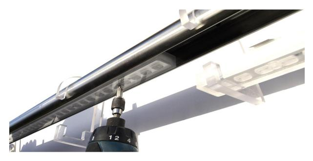
LED-Leuchte befestigen. Ein 3 mm Inbusbit wird mit geliefert .
