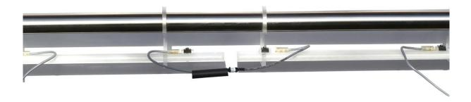
Anschluss der LED-Leuchten mit Stecker/Kupplung und zusätzlichen Schrumpfschlauch mit Innenkleber für eine Verbindung IP 67 Maximaler Strom bei dieser Montagevariante 5 Ampere
